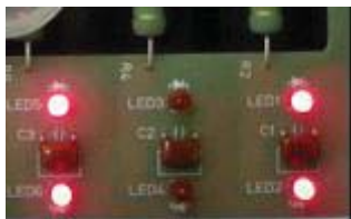
Рис. 2-12 Индикация LED при обрыве V фазы.
