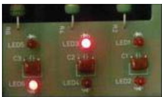
Рис. 2-10 Пример индикации управления защитой компрессора. (Не заканчивайте определение неисправностей на этом этапе).
