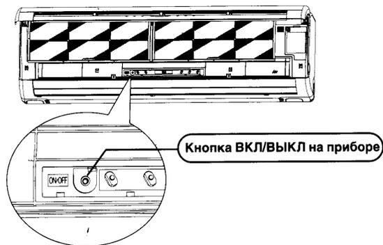
Кнопка ВКЛ/ВЫКЛ на приборе
