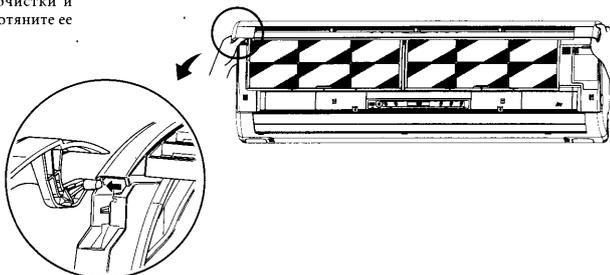
Закрепите верхний или нижний край панели воздухоприемника, путем легкого нажатия на нее, а затем закройте панель.
