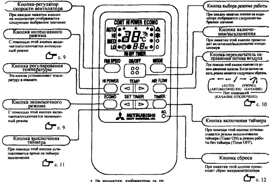
\* На индикаторе, изображенном на рисунке, высвечиваются все возможные элементы, однако при работе с кондиционером в каждый момент времени высвечивается только актуальная информация.
