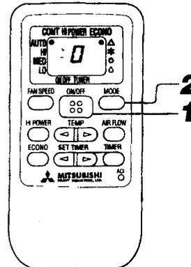
Регулировка направления потока воздуха. с. 10
